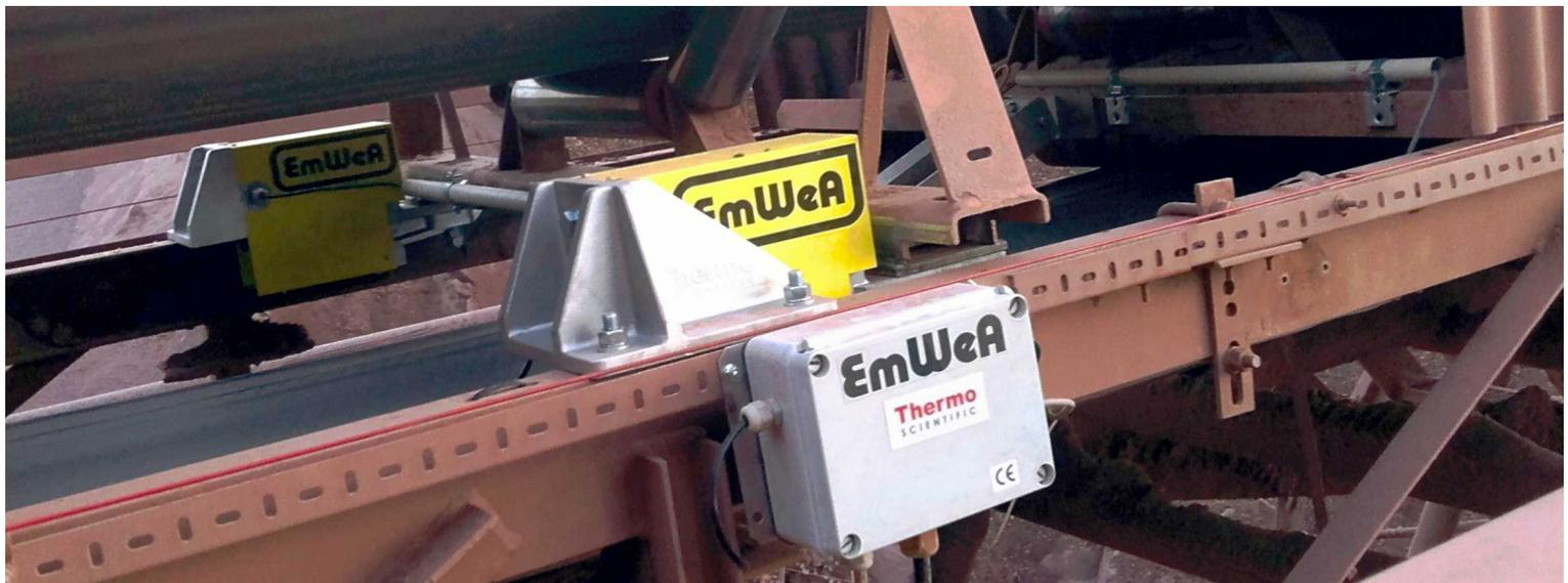
Die Bandwaage IDEA besteht aus der modular aufgebauten Wägemechanik IDEA und dem Geschwindigkeitsgeber ZA-11. Es werden außerdem die leistungsstarken, vielseitigen und modernen Auswerteelektroniken (Integratoren) der Serie Ramsey™ Flex eingesetzt.
