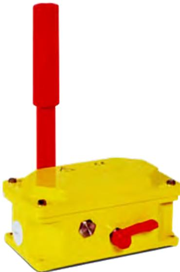
Robuster Bandschieflaufschalter. Zwei Schaltelemente werden von unterschiedlichen Nocken auf der Welle betätigt.
