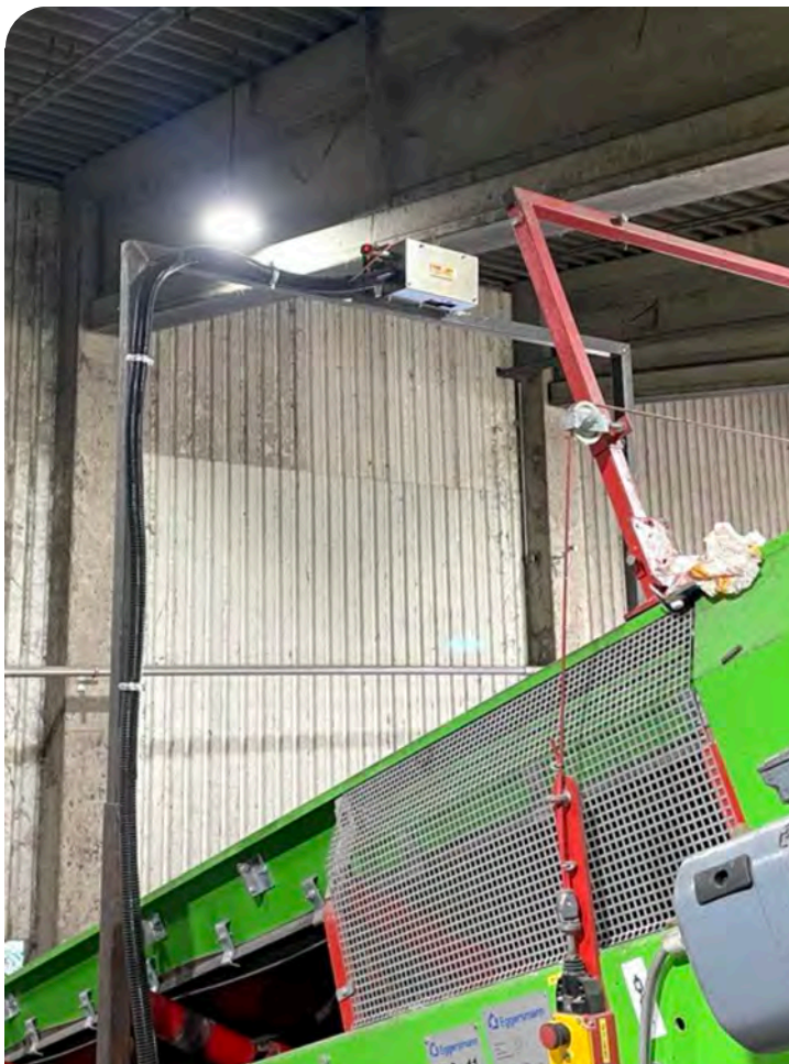
Messung von Abfall auf einem Förderband
