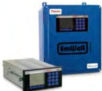
Es stehen unterschiedliche Elektroniken für verschiedene Anforderungen zur Verfügung. Wählen Sie ein wetterfestes Vor-Ort-Gehäuse oder einen DIN-Schalttafeleinschub. Eine Vielzahl von optionalen Schnittstellen, wie binäre und analoge Ein- und Ausgänge, RS232, RS485, Profibus DP, Ethernet/IP oder USB ermöglichen die einfache Anbindung an kundenseitige Prozessleitsysteme und Steuerungen. Wir erstellen für Sie gern ein individuelles Angebot!
