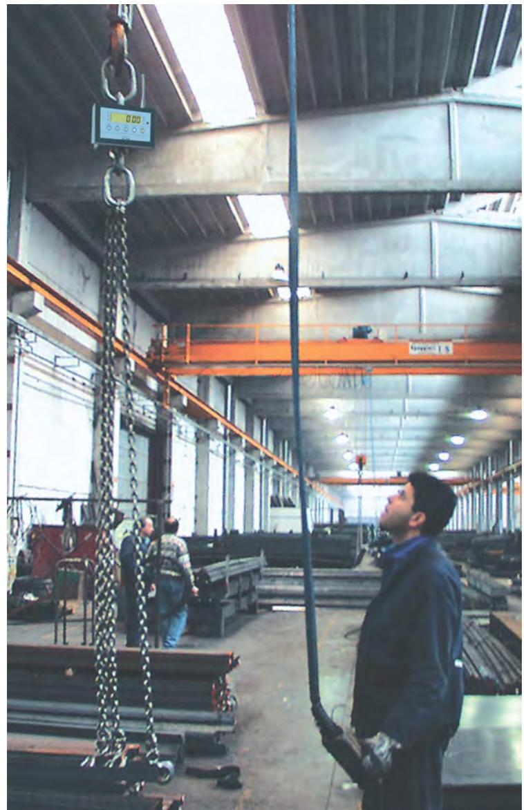
Für eichpflichtige Wägungen stehen OIML-konforme Kranwaagen zur Verfügung. Zum Nachweis dient der integrierte Alibispeicher (Option). Versionen mit ATEX-Zulassung für explosionsgefährdete Bereiche sind ebenfalls erhältlich.
